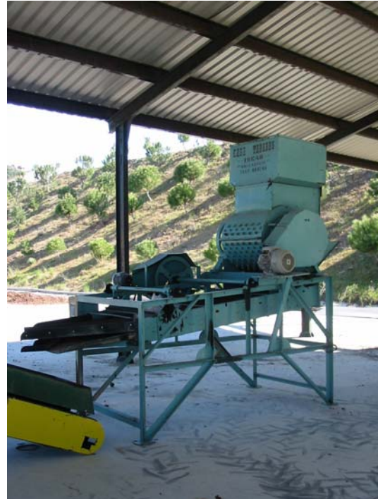
Desgranadora de piñas + criba horizontal
